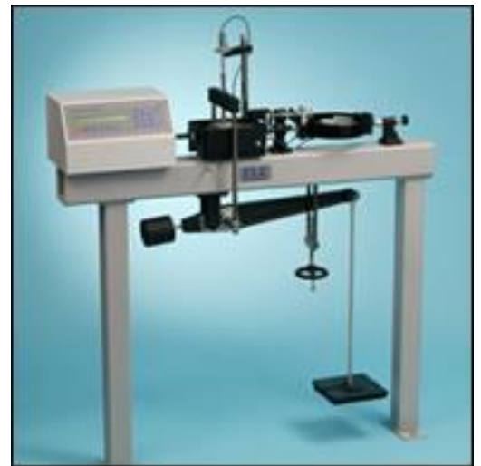
Նկ.14. ԿՈՄՊՐԵՍԻԱՅԻ ՓՈՐՁԱՐԿՄԱՆ ԵՎ ՍԱՀՔԻ ԴԻՄԱԴՐՈՒԹՅԱՆ ՈՐՈՇՄԱՆ ՍԱՐՔԱՎՈՐՈՒՄՆԵՐԸ
