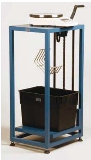
Նկ.12. ԲԵՏՈՆԻ ԽՏՈՒԹՅԱՆ ՈՐՈՄԱՆ ՀԻԴՐՈՍՏԱՏԻԿ ԿՇՌՄԱՆ ՀԱՄԱԿԱՐԳ
