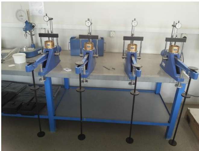
Նկ.14. ԿՈՄՊՐԵՍԻԱՅԻ ՓՈՐՁԱՐԿՄԱՆ ԵՎ ՍԱՀՔԻ ԴԻՄԱԴՐՈՒԹՅԱՆ ՈՐՈՇՄԱՆ ՍԱՐՔԱՎՈՐՈՒՄՆԵՐԸ
