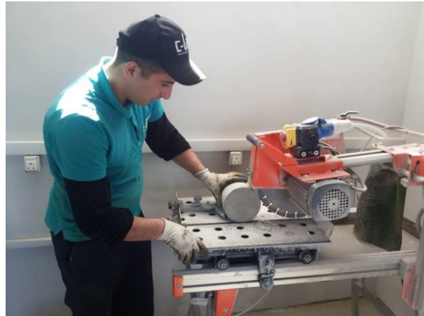
Նկ.11. ՀՈՐԱՏՎԱԾ ԲԵՏՈՆԵ ՆՄՈՒՇԻ ՄԱԿԵՐԵՍԻ ՄՇԱԿՄԱՆ ԳՈՐԾԸՆԹԱՑԸ
